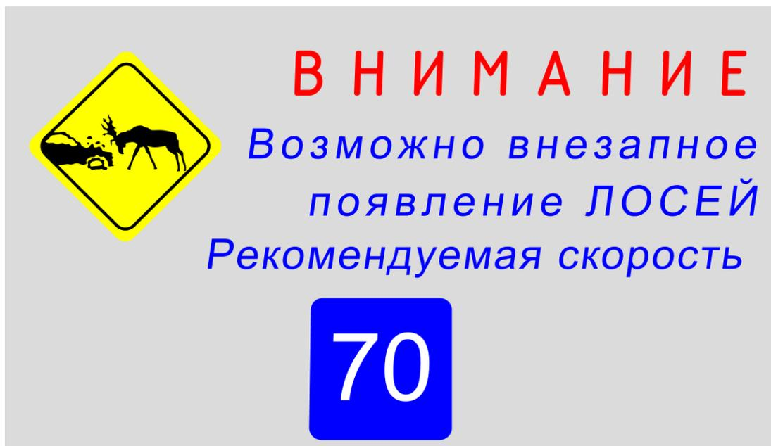
Рисунок Г.4 – Пример оформления щитов с видом животного и рекомендуемой скоростью движения
